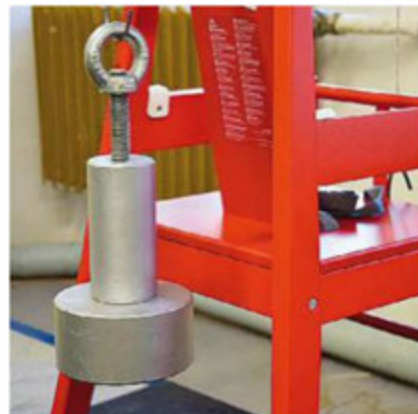
Při zkouškách stability se používá 15kilové závaží.
